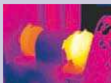
Przegrzana pokrywa łożyska
