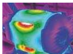
Nietypowy lub nierównomierny rozkład temperatury na silniku
