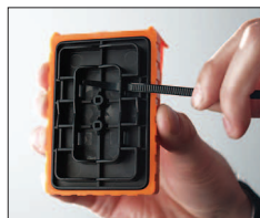
Rys.4: Mocowanie opaski zaciskowej w tylnej części obudowy wskaźnika.
